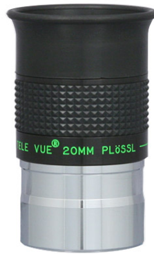
Fig. 69. Ocular TeleVue Plössl de 20 mm de distância focal, campo (FOV) aparente de 50°. Créditos: Tele Vue.
